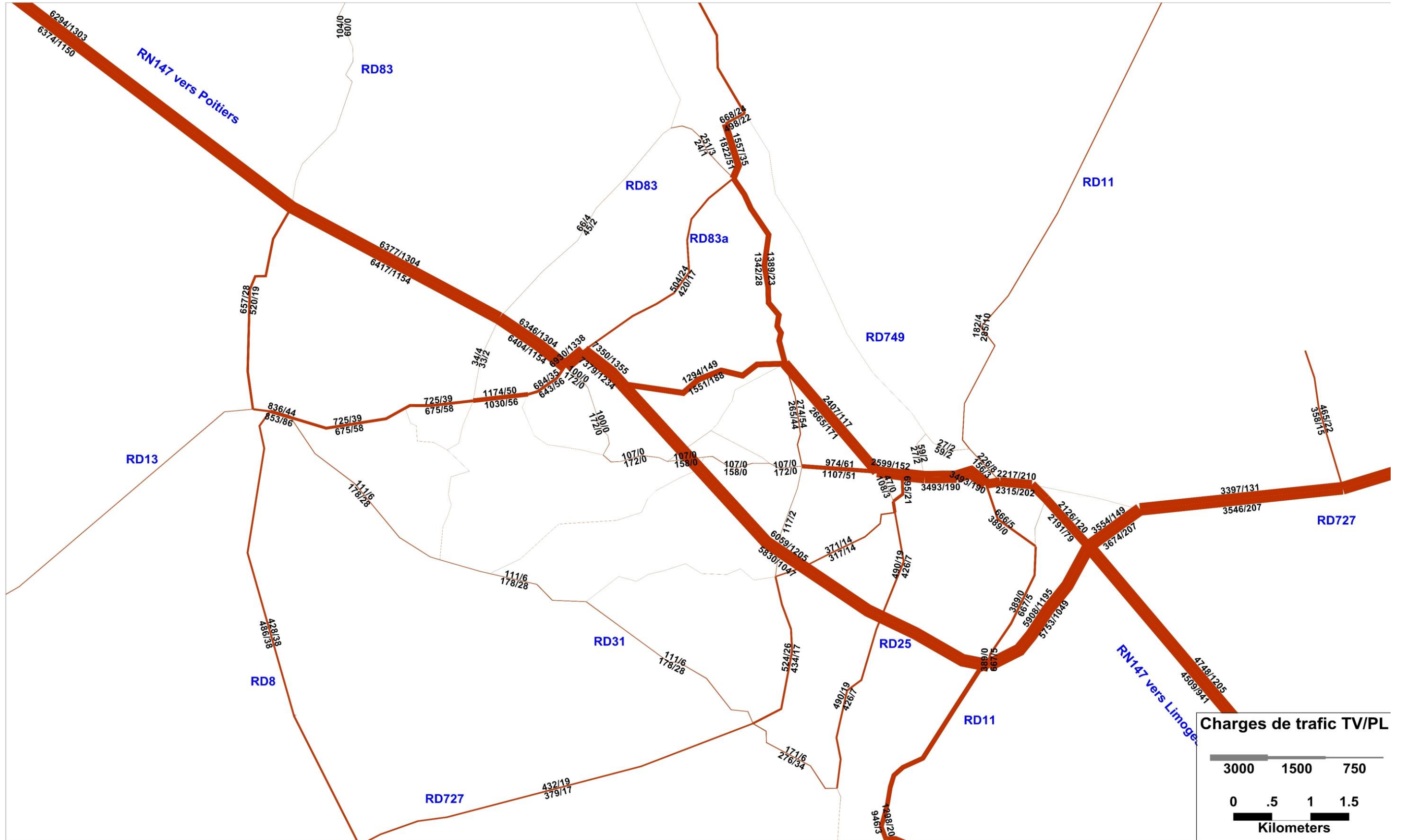
Charges de trafic TMJA TV/PL du Scénario 4 : VJLGV à 2x2 voies à l'horizon 2042
