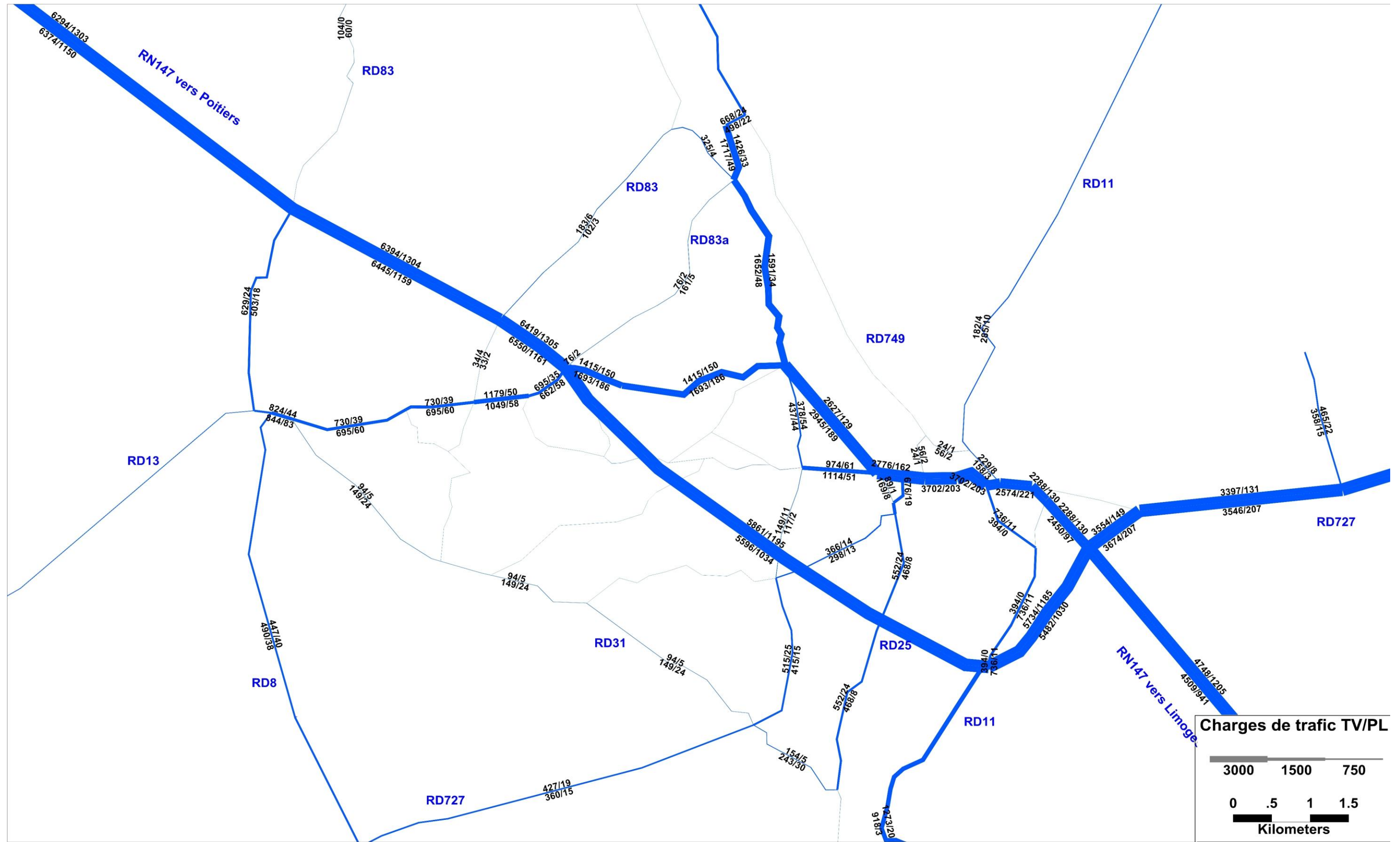
Charges de trafic TMJA TV/PL du Scénario 2 : V2006 à 2x2 voies à l'horizon 2042
